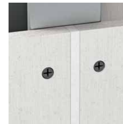
Tmelená spára fermacell™ – šířka spáry: 1/2 x tloušťka desky + max. 3 mm
